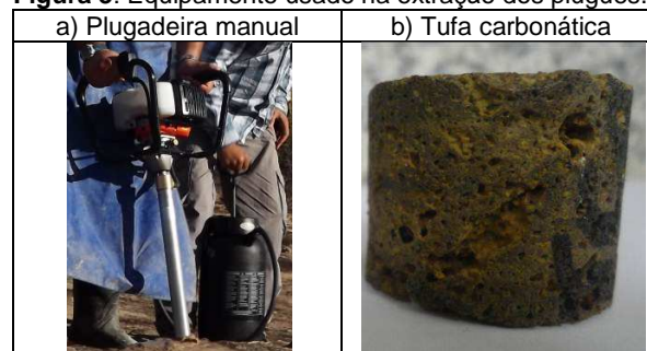
Figura 3: Equipamento usado na extração dos plugues.
